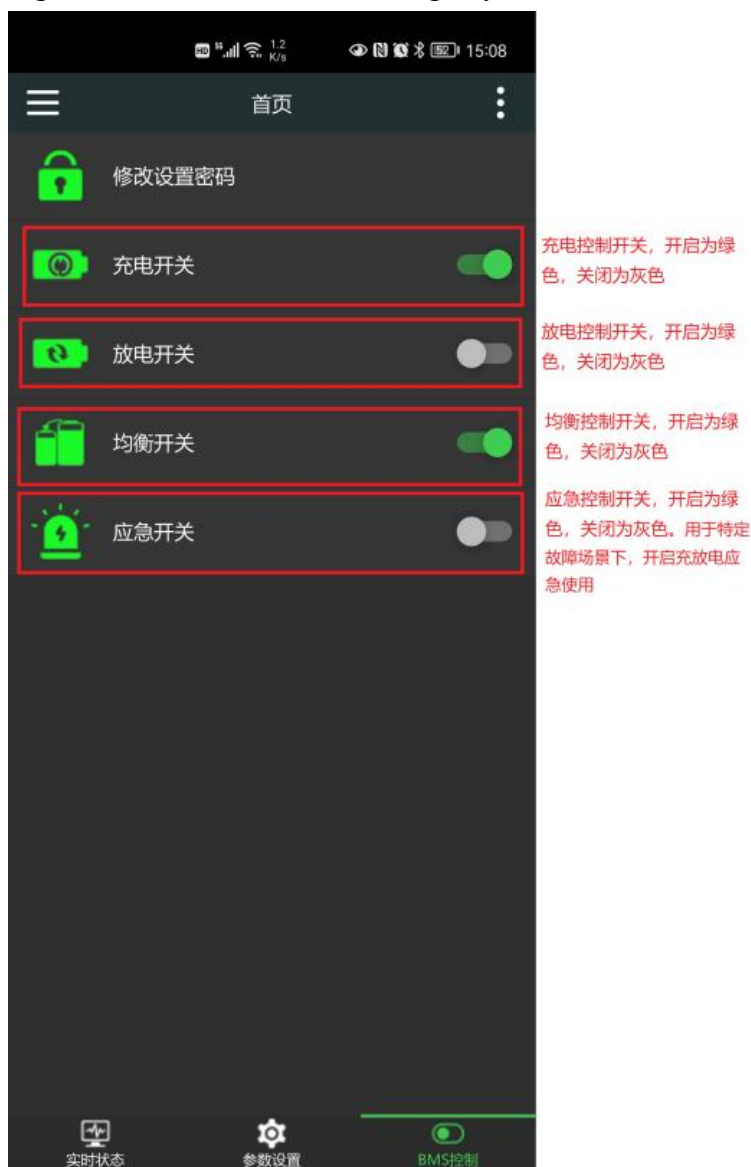
图 23 BMS控制页 Figure 23 BMS control page
